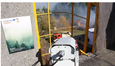
Comprobouse o funcionamento dos sensores infravermellos de terra, que detectan focos de calor.
